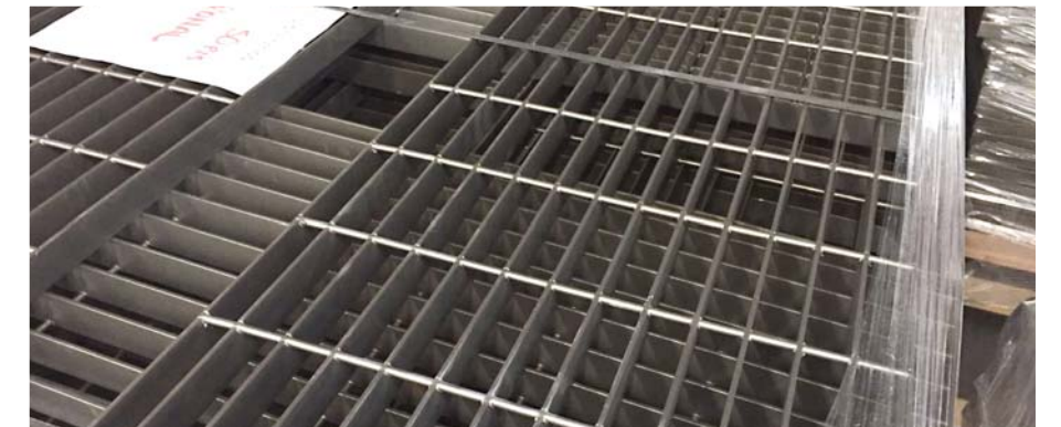
Rejillas después de tratamiento térmico
